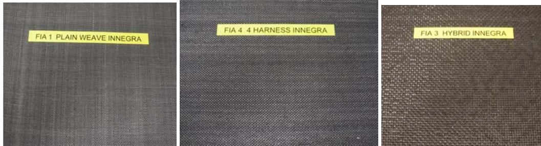
**Figure 1:** *Innegra prepreg samples.*
